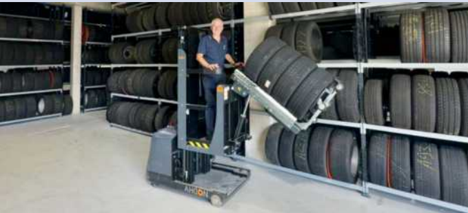
Marcus Mast in der neuen Halle mit einem der ebenfalls neuen „Wheel Trolley Tower Lifts“, die einen Teil der „schweren“ Arbeit mit den Reifen erleichtern.
